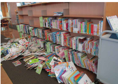
前震後 書架上部のみから落下
