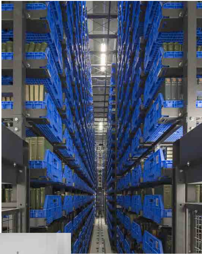
自動書庫と出納ステーション 膨大な資料の中から要求した図書を出納ステーションまで搬送する。
