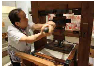
ぶどう絞りの要領でネジ式のレバーを手前に引くと 圧盤が下がり圧力がかかる
