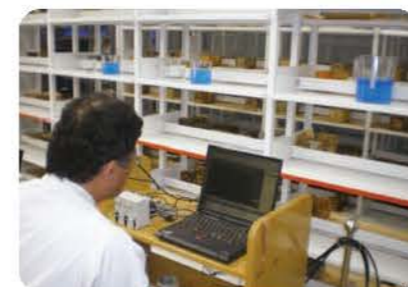
電動棚の駆動試験。棚には標本に見立てた錘をのせて 加速度センサーを設置し、マイコンの設定を最適化した。
